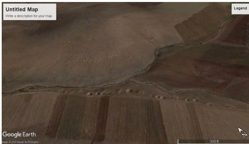
تصویر ۴ عکس هوایی قنات کهریز چهر و نحوه چیدمان چاه های قنات (Google Earth)
